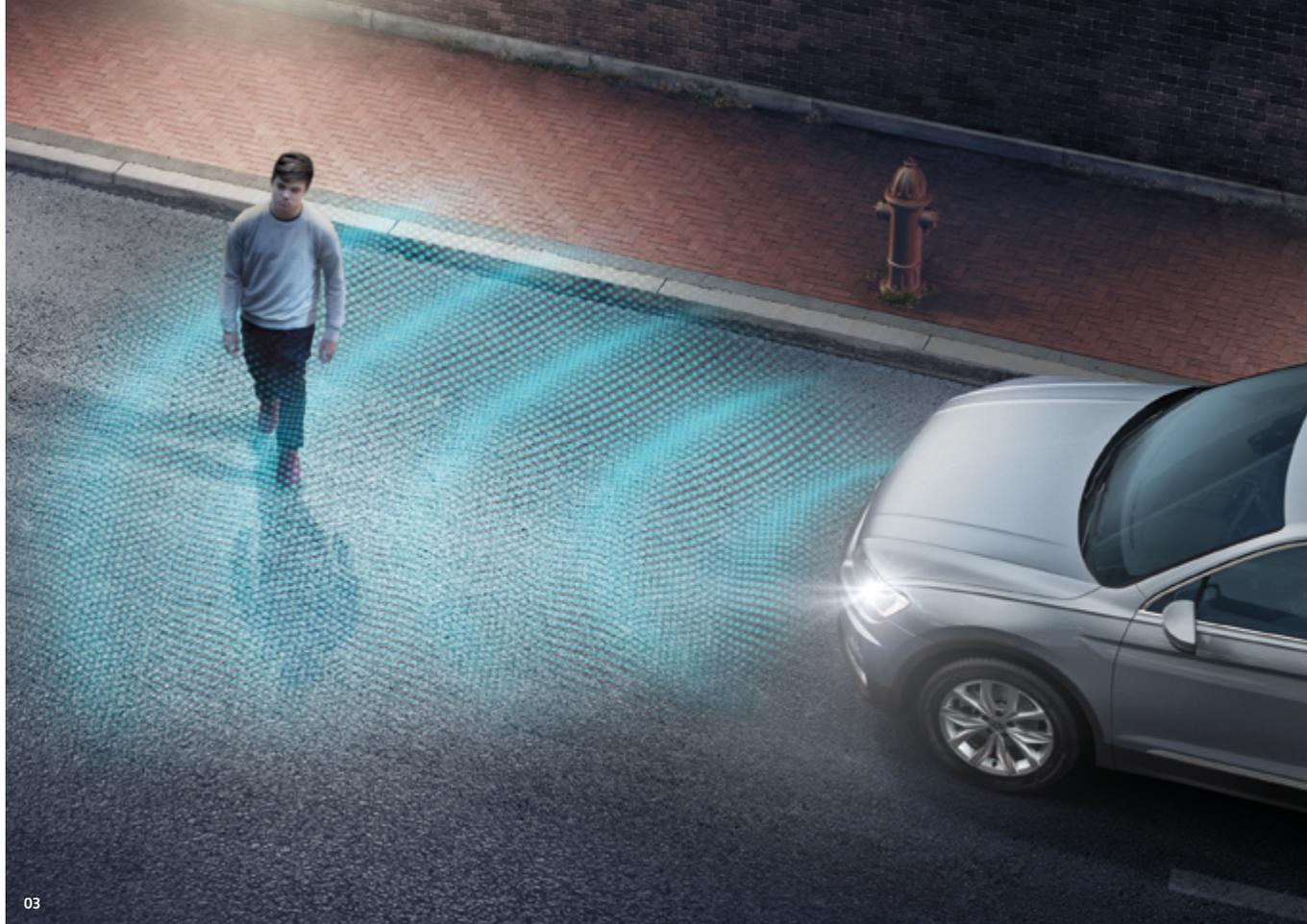
03 Cuida de ti, y de todos los demás: en el Tiguan el sistema de observación del entorno "Front Assist" con Freno de emergencia en ciudad "City Emergency Break" y detección de peatones incluidos, detecta los peatones y demás obstáculos en la calzada y avisa al conductor con la debida antelación.<sup>1</sup> Si no se reaccionara, frena automáticamente el vehículo. **E**
