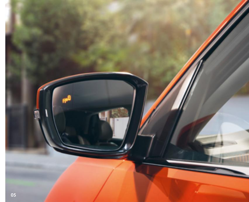
**05** Durante la conducción, el detector de ángulo muerto «Blind Spot» te avisa si hay vehículos fuera de tu ángulo de visión, a través de los LED de los retrovisores exteriores.<sup>1</sup> Al aparcar marcha atrás, el asistente de salida del aparcamiento integrado puede controlar la zona situada detrás de tu vehículo y, de este modo, avisarte del tráfico cruzado.<sup>1</sup> **E**
