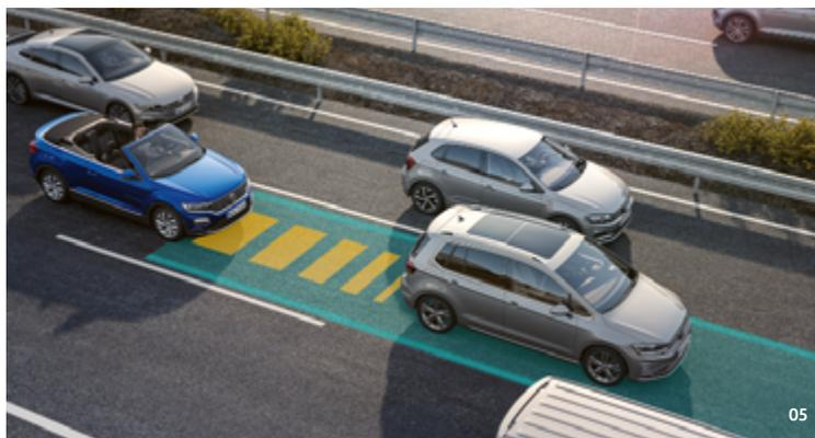
**02** El sistema automático de control de distancia ACC, te ayuda a mantener tanto una velocidad máxima previamente definida<sup>1</sup> como una distancia estable al vehículo que va delante.<sup>2</sup> Así, en los atascos, tu nuevo T-Roc Cabrio puede frenar y volver a arrancar automáticamente (En combinación con caja de cambios DSG opcional). **S R**
