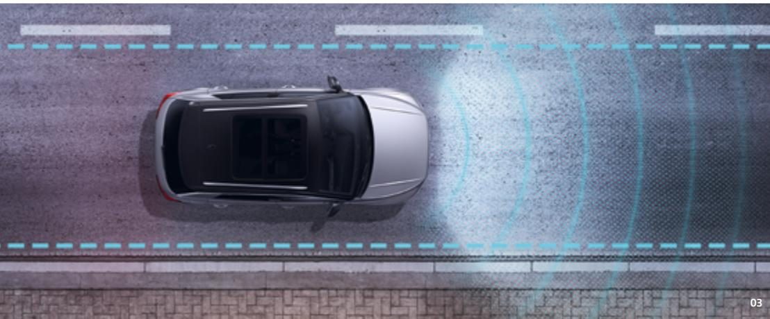
**03** En trayectos largos, la concentración del conductor puede disminuir. Por suerte, el nuevo T-Roc viene equipado de serie con el asistente de abandono de carril **"Lane Assist"** que ayuda a evitar accidentes. Este sistema detecta, dentro de sus límites, las marcas del carril con ayuda de una cámara e inicia una corrección de la dirección en caso de desviarse del mismo. **E**
