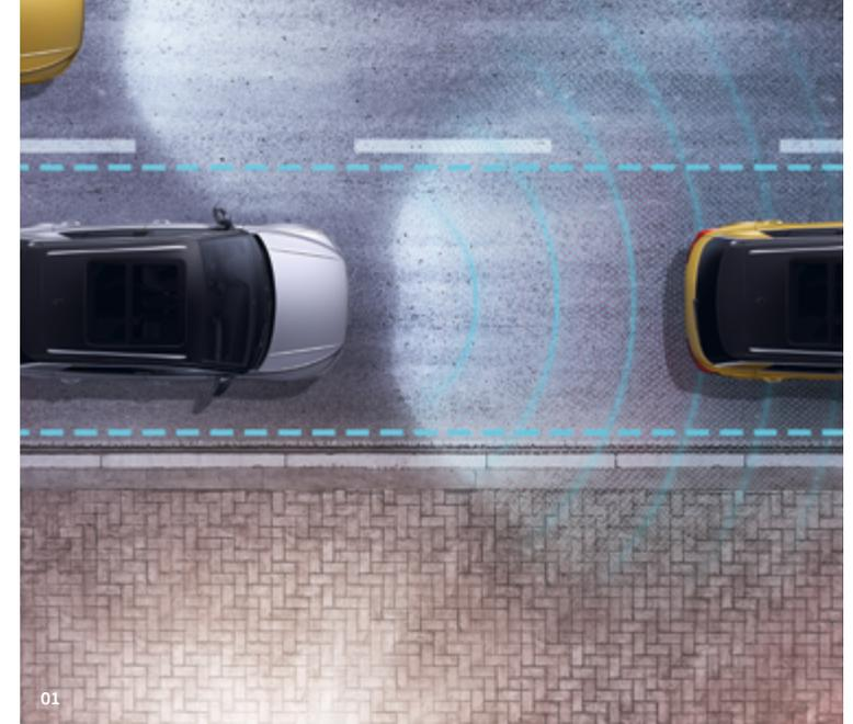
**01** El nuevo T-Roc con ACC sigue al vehículo que circula por delante y controla el acelerador y los frenos, dentro de los límites del sistema. **A**
