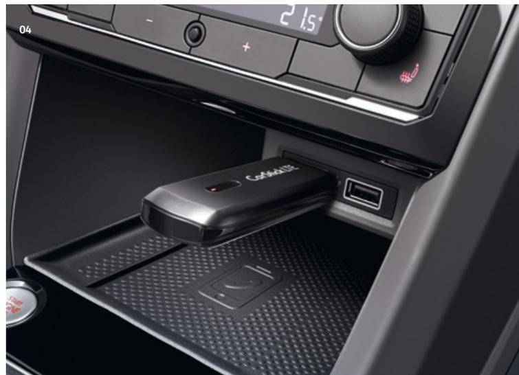
**05** La **interfaz telefónica «Comfort»** permite mantener una conversación relajada mientras circulas. Especialmente práctico: el compartimento integrado con función de carga inductiva y conexión inductiva a la antena externa garantizan una recepción realmente silenciosa con la función manos libres. Se puede controlar cómodamente a través de la pantalla multifunción, el volante multifunción o la pantalla táctil de la radio. **O**
