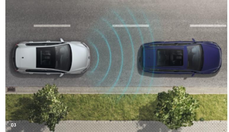
**03** La **regulación automática de la distancia "ACC"** adapta automáticamente la velocidad a la velocidad máxima programada<sup>2</sup> para el vehículo que circula por delante y mantiene la distancia preseleccionada por el conductor<sup>1</sup>. En combinación con el cambio de doble embrague DSG este sistema también incluye, entre otros equipamientos opcionales el sistema **"Emergency Assist"** y el **Traffic Jam Assist**. **O**
