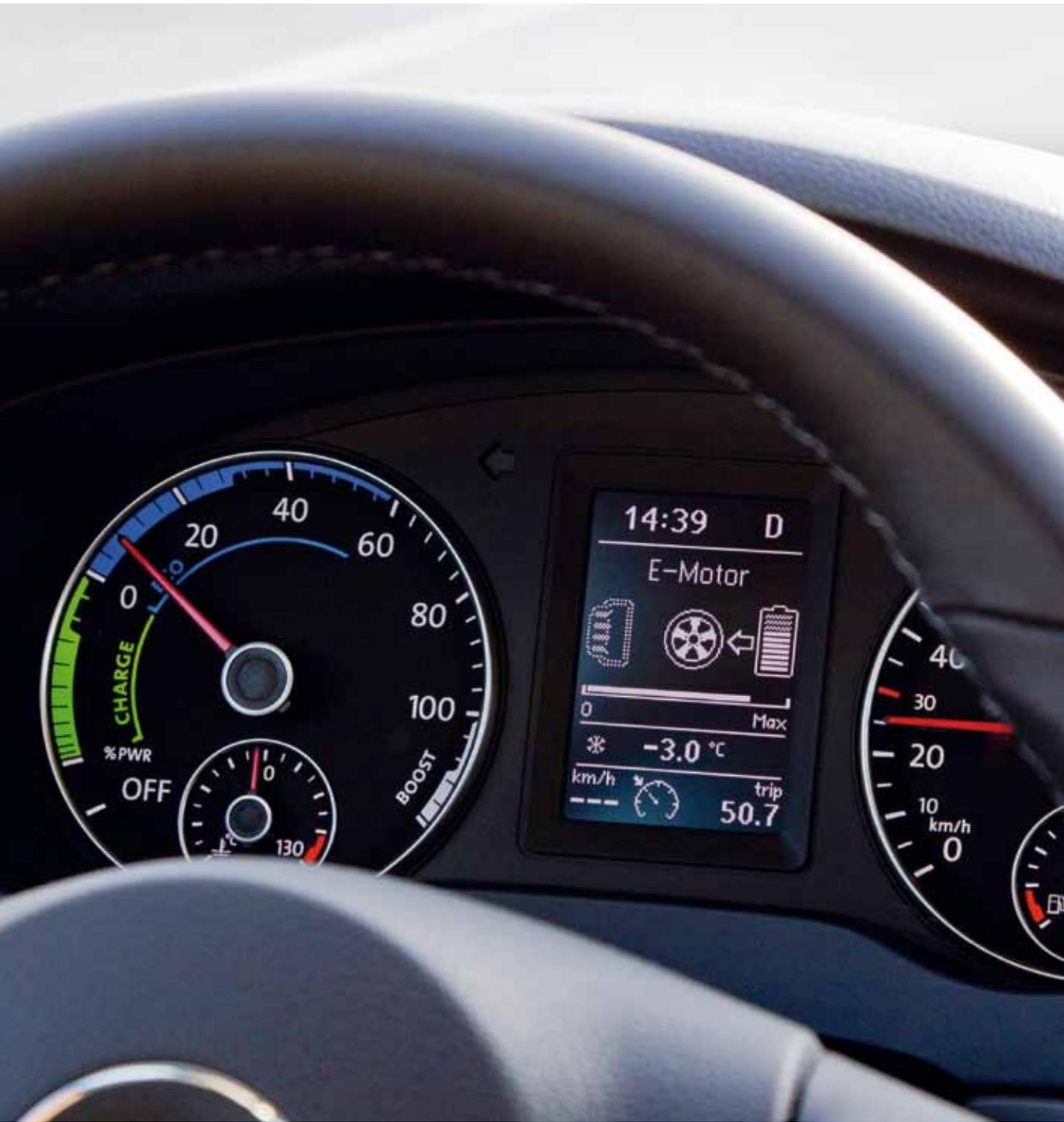
sería necesaria para desplazar el Volkswagen. Este exceso de energía se utiliza de forma selectiva: dependiendo del estado de carga actual de la batería, el exceso de energía se transfiere a la batería de alto voltaje a través del motor eléctrico que, en este caso, funciona como generador. Las denominadas “fases de carga activas” combinadas con las “fases de conducción eléctrica” se han adaptado para minimizar el consumo en la medida posible.
