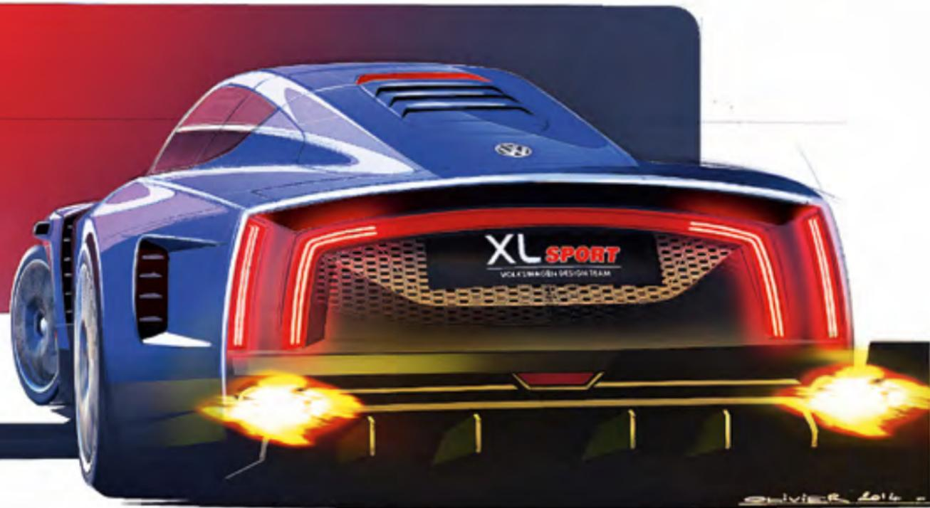
(articulación como biela de empuje superior). Salta a la vista que estas características muestran paralelas con el deporte automovilístico. Los neumáticos de alta velocidad de 205/40 R 18 (delante) y 265/35 R 18 (detrás) se calzan sobre llantas de magnesio forjado que, en comparación con las llantas de aluminio, ahorran un peso total de 23,9 kilogramos. El sistema de frenos del XL Sport es extremadamente resistente y dispone de discos cerámicos.
